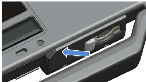
È possibile inserire completamente la scheda Secure Digital lasciando chiuso lo sportello di protezione. Inserire la scheda nello slot per Secure Digital fino a quando non è completamente posizionata nel proprio connettore. Per sbloccare la scheda Secure Digital, premere il bordo della scheda verso l'interno finché il lettore non espelle la scheda.
