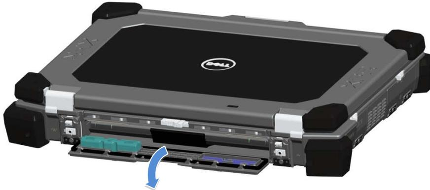
3. Premere verso l'esterno le due chiusure a scatto della batteria situate sulla parte inferiore del computer.
